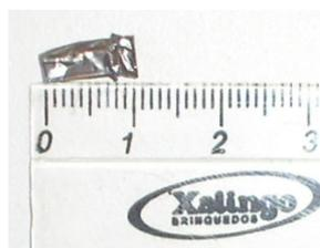
Figura 5.4 - Amostra no envelope de Tântalo para tratamento em forno tipo Mufla.
