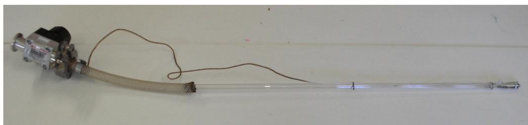
Figura 5.5 - Amostra no interior do tubo de quartzo utilizado nos tratamentos térmicos.
