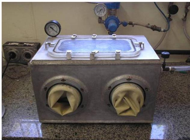
*Figura 5.1 - Caixa de luvas utilizada para pesagem, manipulação dos pós-elementares e das amostras moídas, bem como selegem do vial (recipiente de moagem) em atmosfera controlada.*
