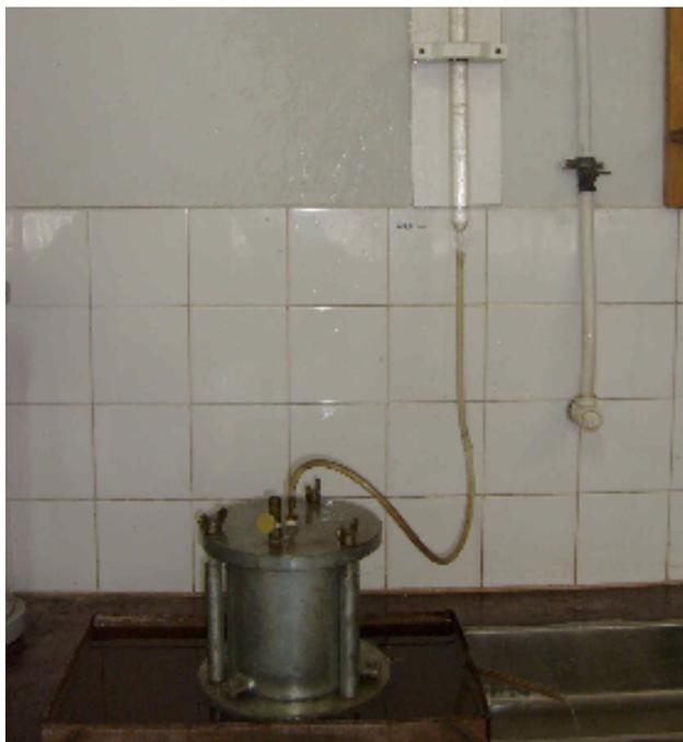
Figura 10- Permeômetro utilizado nos ensaios de permeabilidade.
