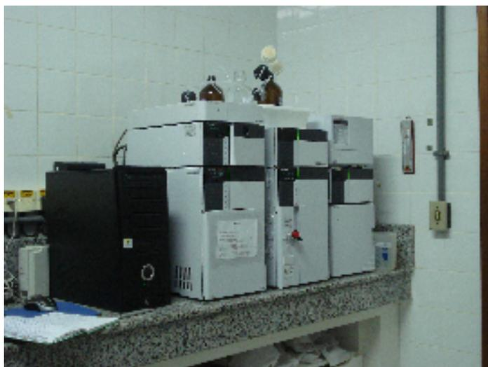
Figura 15 - Cromatógrafo utilizado nas análises de hidrocarbonetos aromáticos.
