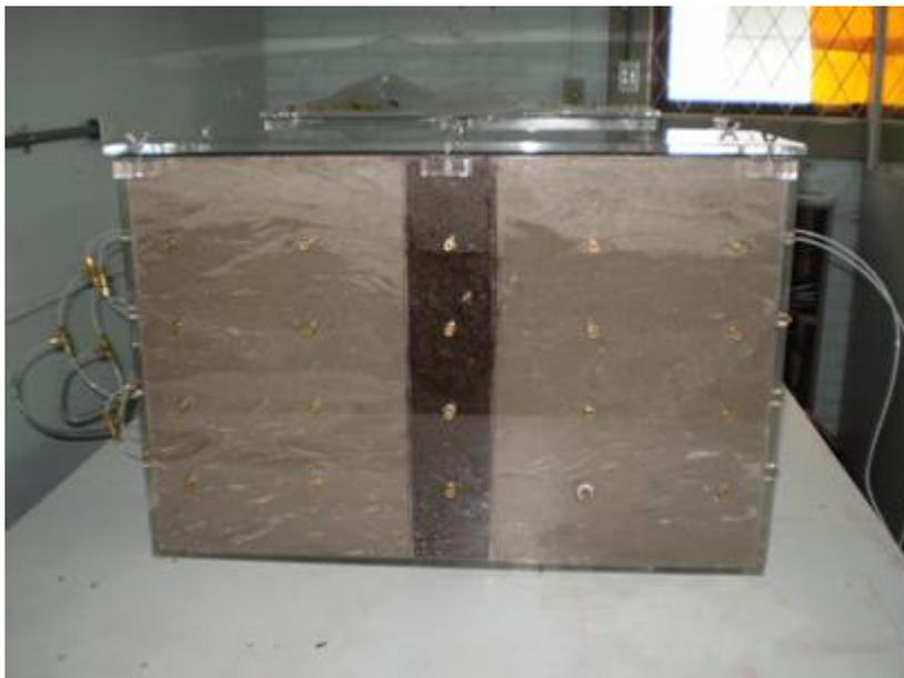
Figura 13 - Protótipo contendo a BRP constituída por areia e turfa.
