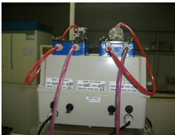
Figura 32 - Bomba peristáltica após 1 dia do início dos experimentos indicando a presença do traçador no interior das tubulações.
