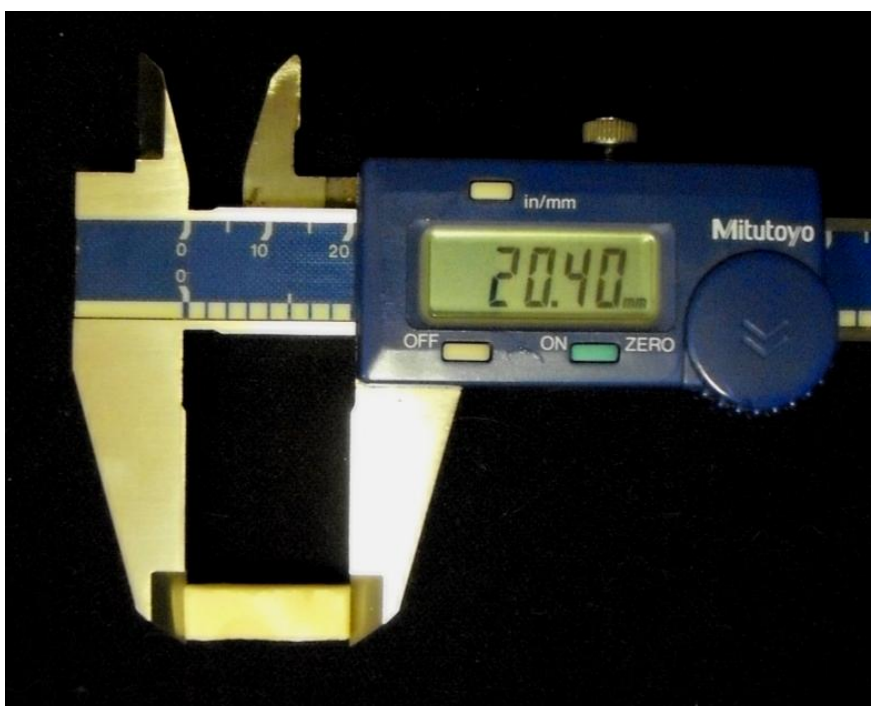
Figura 2 - Corpo de prova sendo mensurado com auxílio de um paquímetro digital antes do ensaio mecânico.
