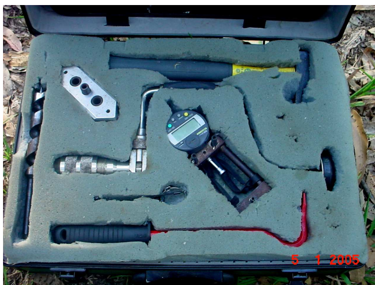
Figura 1 – Detalhes dos instrumentos utilizados para medição da Deformação Residual Longitudinal (DRL), composto pelo extensômetro, pinos de fixação, gabarito de fixação dos pinos (45,0 mm de afastamento) e arco de pua com broca de 20,0 mm.
