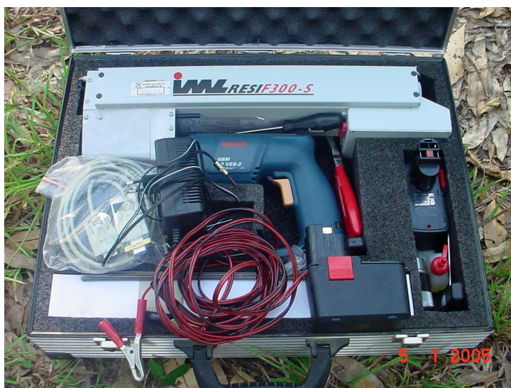
Figura 2 – Equipamento conhecido como Resistógrafo, utilizado na avaliação da qualidade da madeira.
