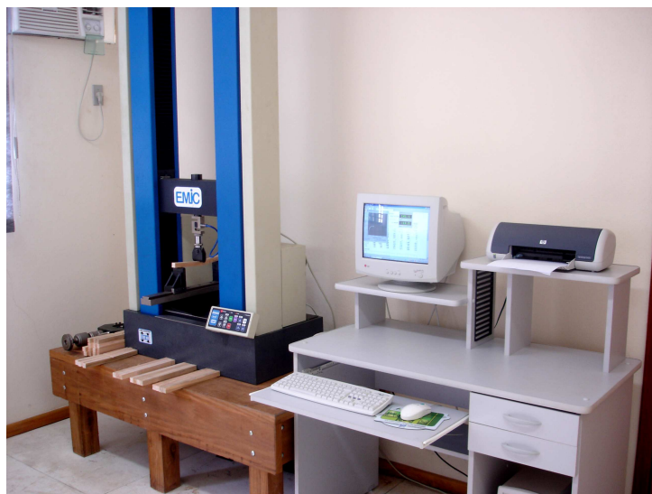
Figura 1 – Máquina universal de ensaios com tomada automática de dados.
