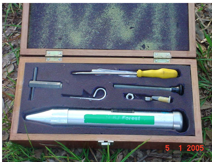
Figura 1 – Equipamento conhecido como Pilodyn, utilizado na estimativa da densidade básica.
