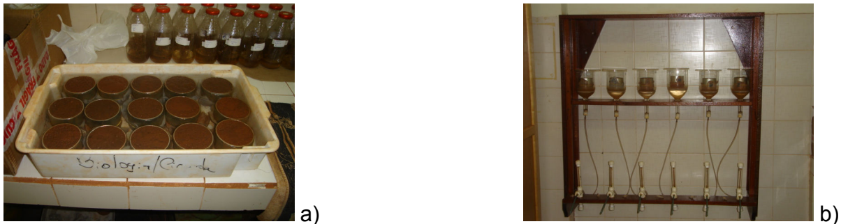
Figura 12- Amostras saturadas para obtenção da densidade do solo, macroporosidade, microporosidade e volume total de poros: a) monólitos saturados, b) unidade de sucção à tensão de 0,06 atm.
