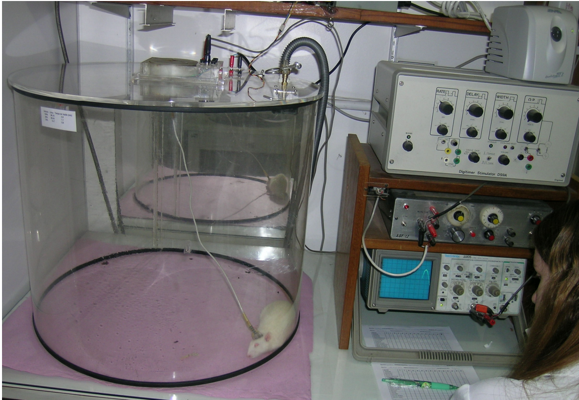
Figura 8. Rato na câmara gasosa para estimulação elétrica na presença de \text{CO}_2 . O rato encontra-se com o cabo de estimulação que faz a ligação com o conector giratório e o gerador de corrente. Observador posicionado a direita para manuseio do aparelho e preenchimento da planilha.
