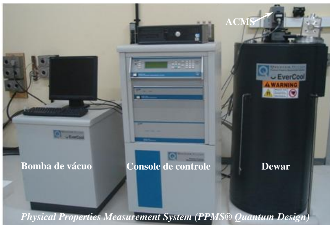
Figura 3.6 PPMS® Quantum Design modelo 6000 com módulo ACMS. (a) Bomba de vácuo; (b) Console de controle; (c) Dewar e (d) ACMS transporte da amostra.
