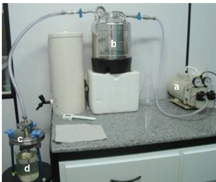
Figura 10: Recipiente de pressão para dispensação (Millipore), constituído por uma bomba à vácuo (a), recipiente onde o volume de água é adicionado (b) e local para inserção da membrana (c). Também é possível visualizar a amostra após filtração (d).
