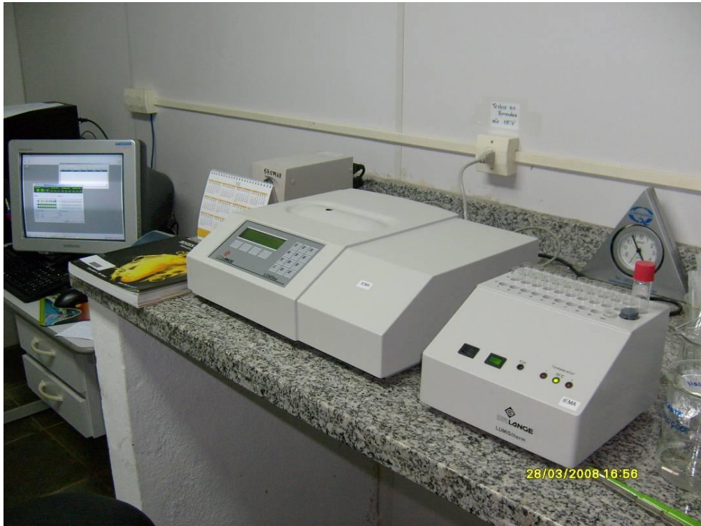
Figura 14 - Lumistox 300 no meio do termobloco e do computador.
