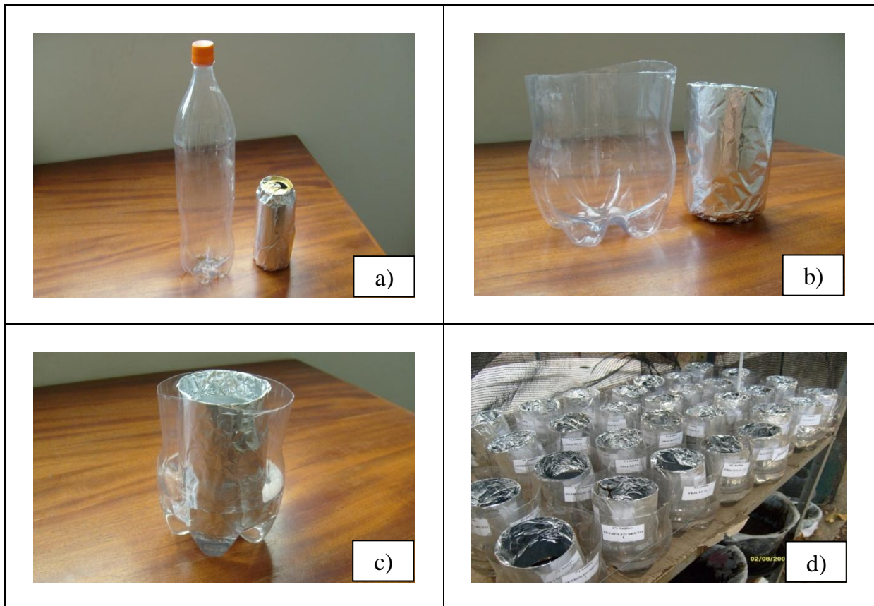
Figura 11 – Unidade experimental Lata/PET. a) Garrafa pet de 2L e lata de alumínio de 350ml. b) Garrafa e lata cortadas. c) Lata dentro da pet com água destilada.d) Unidade experimental instalada na prateleira de metal com experimento em andamento.
