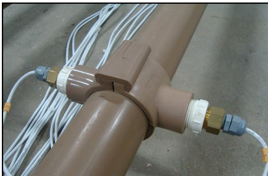
Figura 15 – Posto de instalação do conjunto led de infravermelho e sensor, montados em colar de tomada em posição diametralmente oposta
