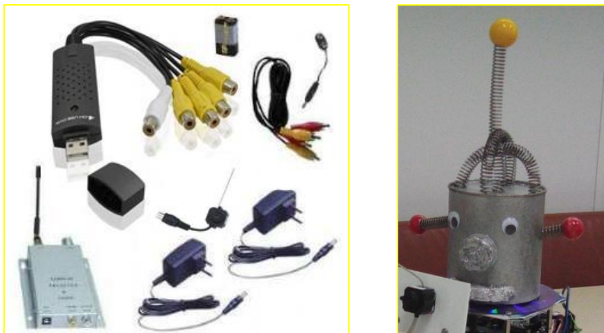
Figura 8 – Componentes extras - câmera de segurança sem fio e conversor de sinal de televisão para entrada USB [21], e o enfeite utilizado no robô.
