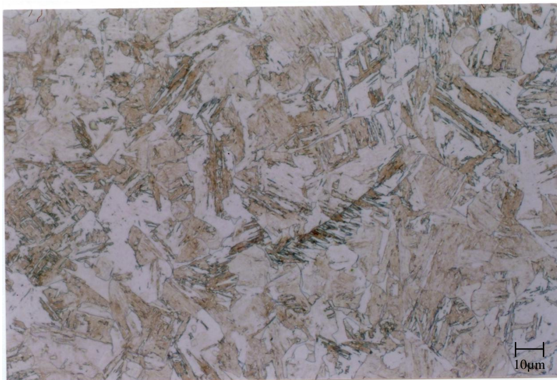
Figura 5.18 - Microestrutura da Zona fundida, condição de soldagem 1 (GTAW com menor frequência). Presença de martensita e ferrita; reativo: Vilella, microscópico óptico, 150X.
