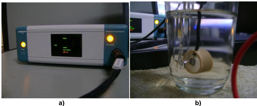
Figura 4.4 - a) Potenciostato \mu Autolab Type III; b) Célula. Eletrodos de: trabalho, calomelano e de platina.
