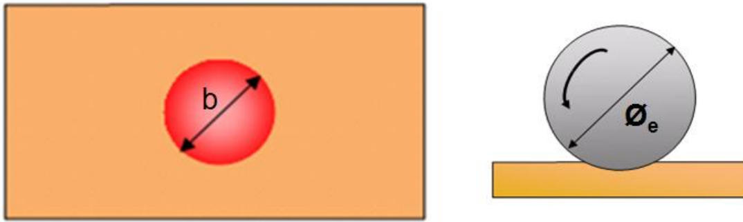
Figura 23 - Calota de desgaste gerada pelo ensaio de microabrasão.
