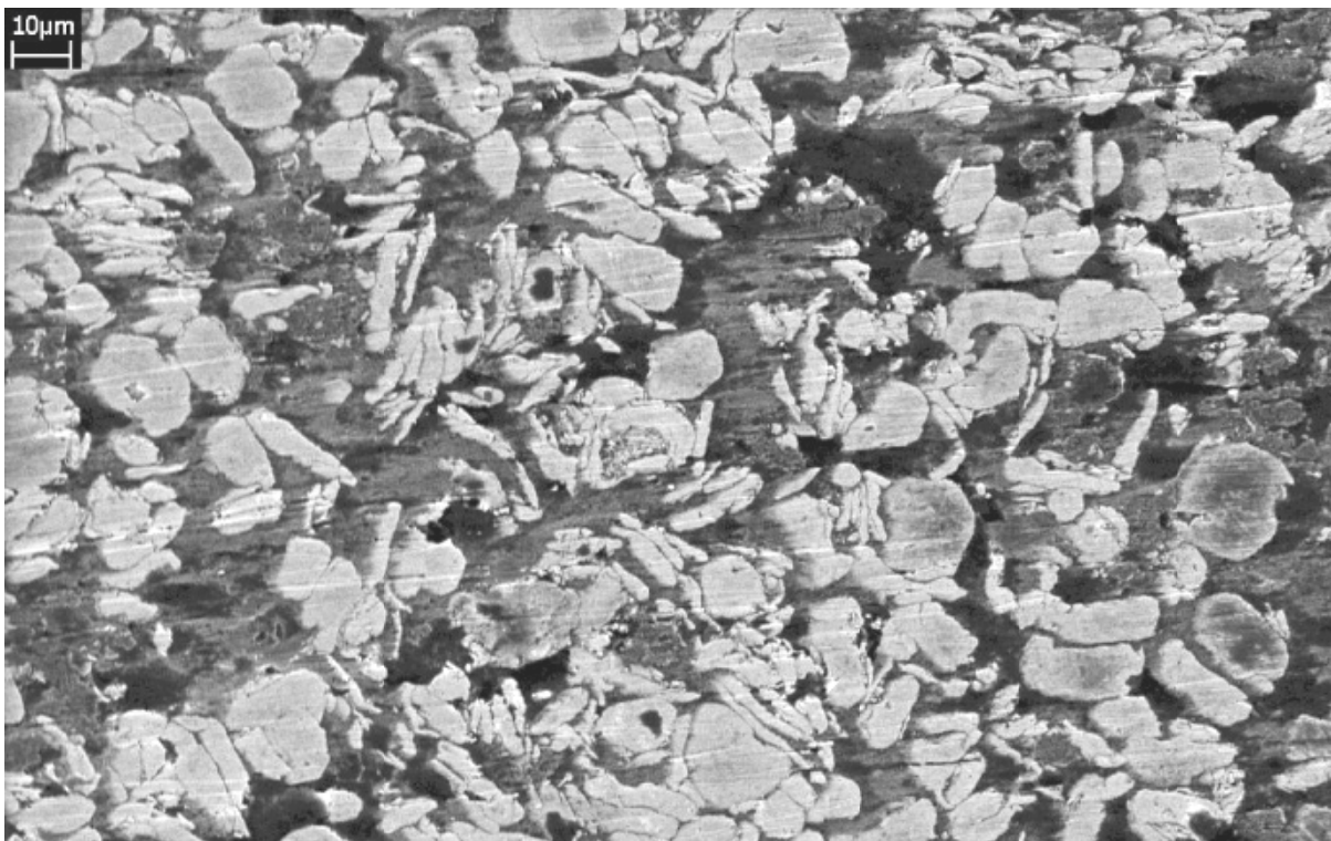
Figura 38 - Micromecanismos de desgaste por deslizamento gerados com lama abrasiva de \text{Fe}_2\text{O}_3 , MEV – Elétrons secundários – Matriz “4-Mo”.
