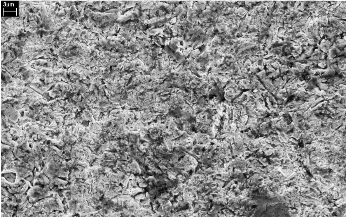
Figura 34 - Micromecanismos de desgaste por indentações múltiplas gerados com lama abrasiva de SiC, MEV – Elétrons secundários – Matriz “4-SiC”
