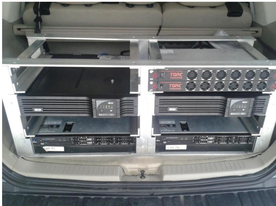
Figura 28: Recursos computacionais do veículo robótico autônomo IARA [86]
