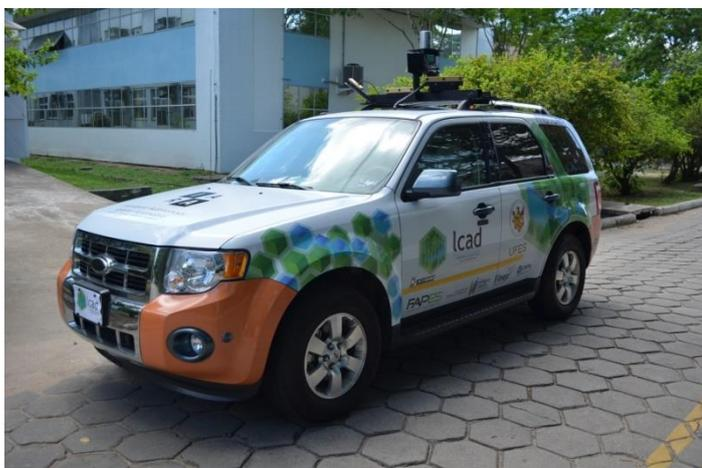
Figura 27: Veículo robótico autônomo IARA
