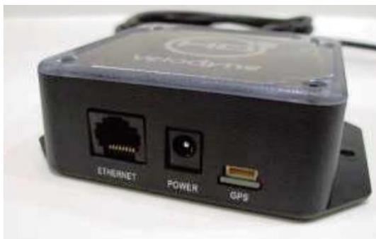
Figura 31: Conexões de dados do LIDAR HDL-32E
