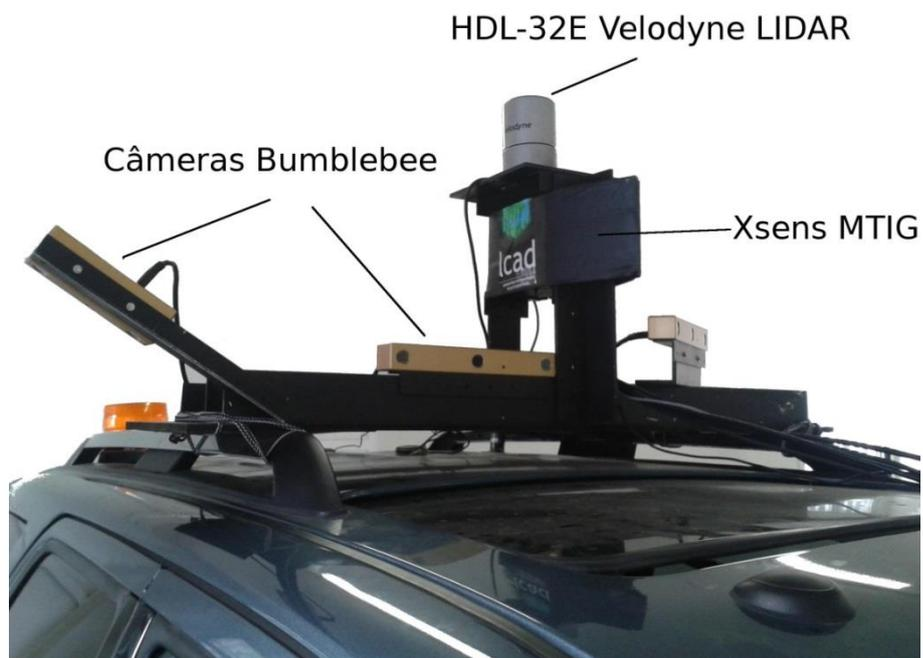
Figura 29: Sensores do veículo robótico autônomo IARA [86]
