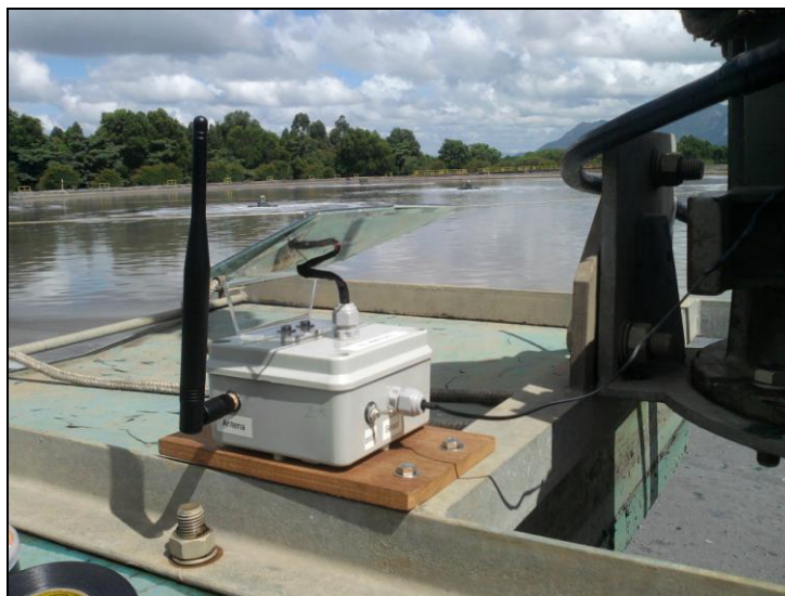
Figura 29 – Kit de monitoramento montados sob a base do motor do aerador.
