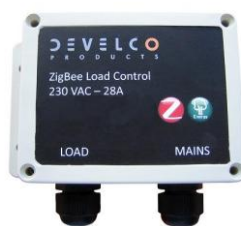
Figura 2 – Nó sensor utilizado para medição de grandezas elétricas.
