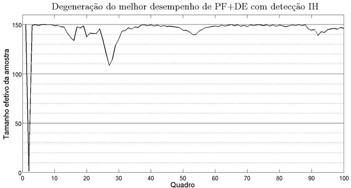
Figura 5.9: Gráfico da medida da degeneração ao longo do tempo do teste com melhor desempenho do Filtro de Partículas com Evolução Diferencial usando Interseção de Histograma
