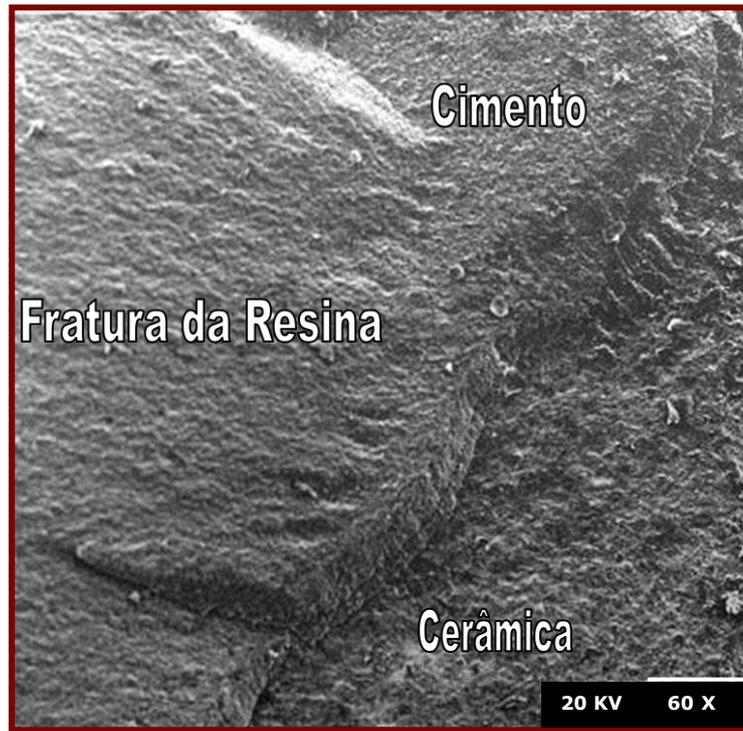
Figura 38 - Falha mista (coesiva do cimento e da resina e adesiva) – análise do fragmento da cerâmica.
