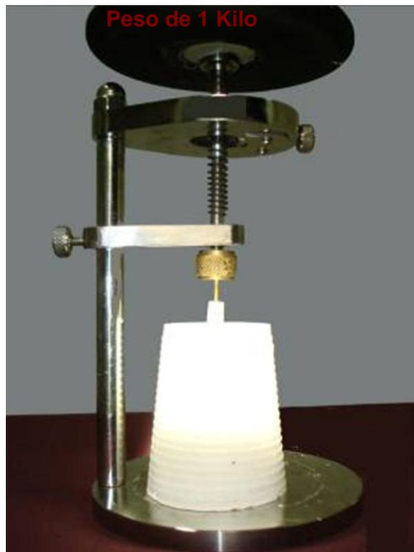
Figura 11 - Dispositivo de cimentação, com corpo de prova posicionado.
