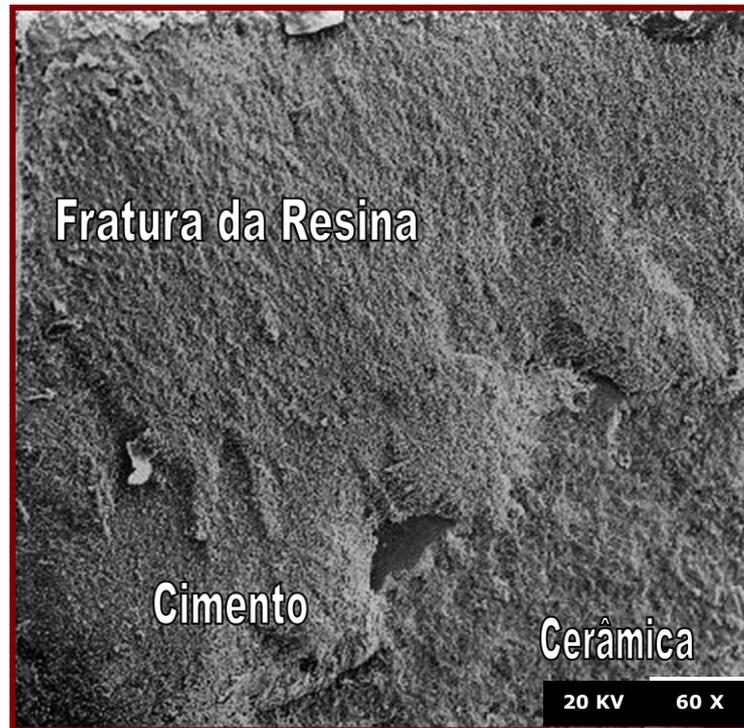
Figura 48 - Falha mista (coesiva do cimento e da resina e adesiva) – análise do fragmento da cerâmica.
