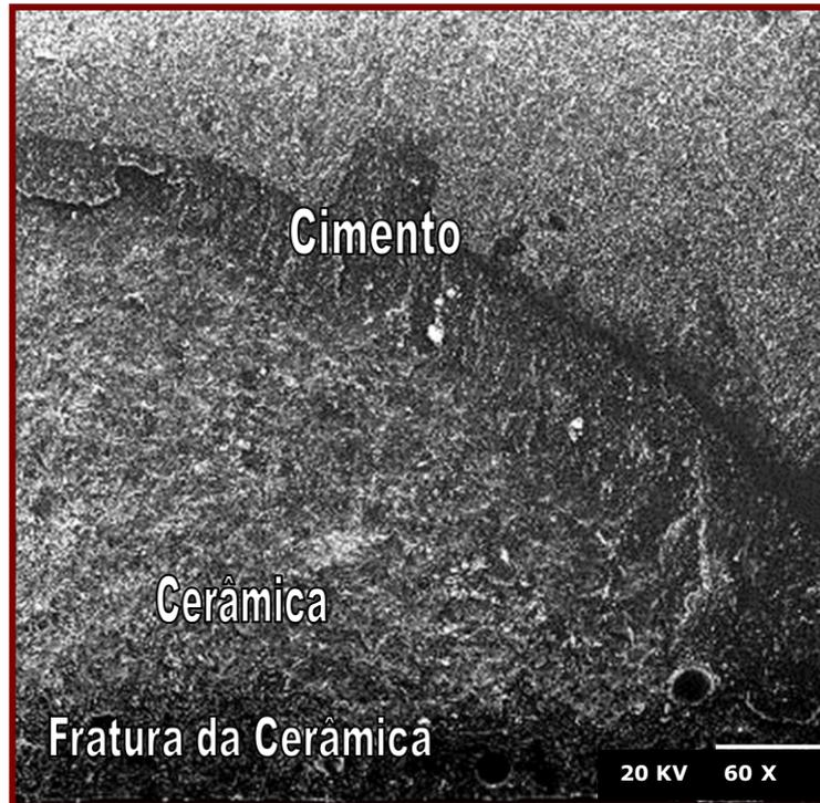
Figura 40 - Falha mista (coesiva do cimento e da cerâmica e adesiva) – análise do fragmento da cerâmica.
