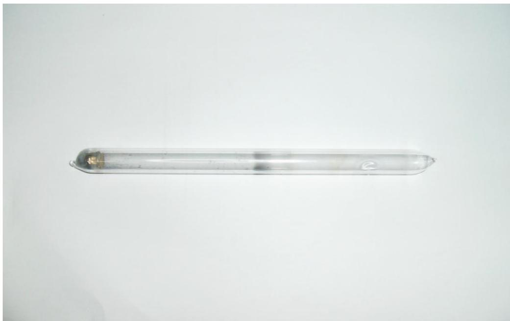
Figura 3.1.2 - Pastilhas no tubo de quartzo após tratamento térmico.
