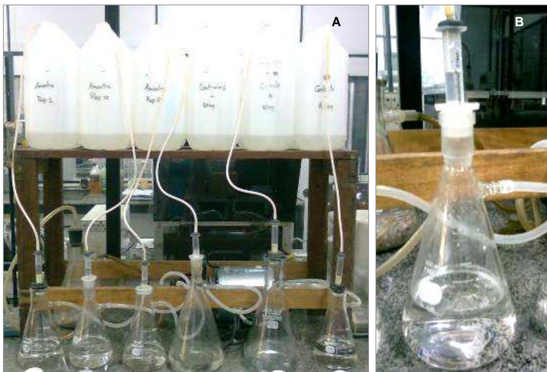
Figura 8- À esquerda, (A) extração em fase sólida dos tratamentos Amostra Bruta e Controle Positivo, (n=3). À direita, (B) amostra percolando o cartucho de extração.
