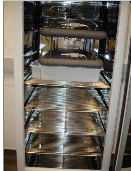
Fotografias 18 e 19 – Loops preenchidos com água tratada com UV e sem tratamento respectivamente.
