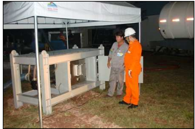
Fotografias 24 e 25 – Equipamento de tratamento UV de grandes vazões equipado em skid para operação embarcado.
