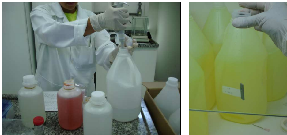
Fotografias 7 e 8 – Preparação dos fluidos e colocação de cupons.
