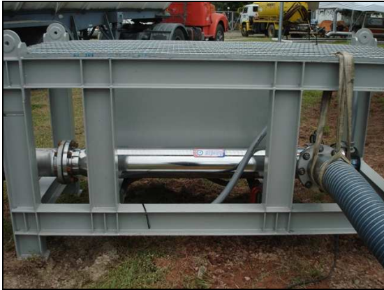
Fotografias 24 e 25 – Equipamento de tratamento UV de grandes vazões equipado em skid para operação embarcado.
