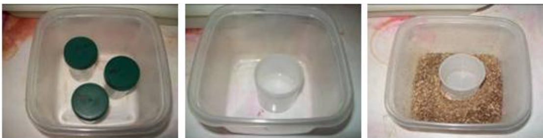
Figura 17 – Unidades experimentais: potes com NaOH, branco e areia + vermiculita.
