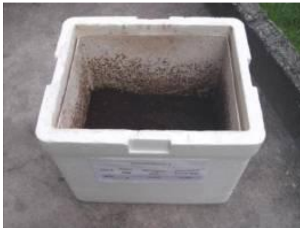
Figura 13 – Reator de compostagem com fezes misturadas a serragem.
