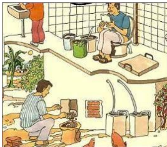
Figura 6 – Esquema ilustrativo de um banheiro com segregação de fezes e urina
