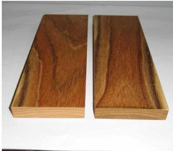
Figura 3.2. Peças de madeiras de *Tectona grandis* orientadas tangencialmente preparadas para serem unidas por adesivos.
