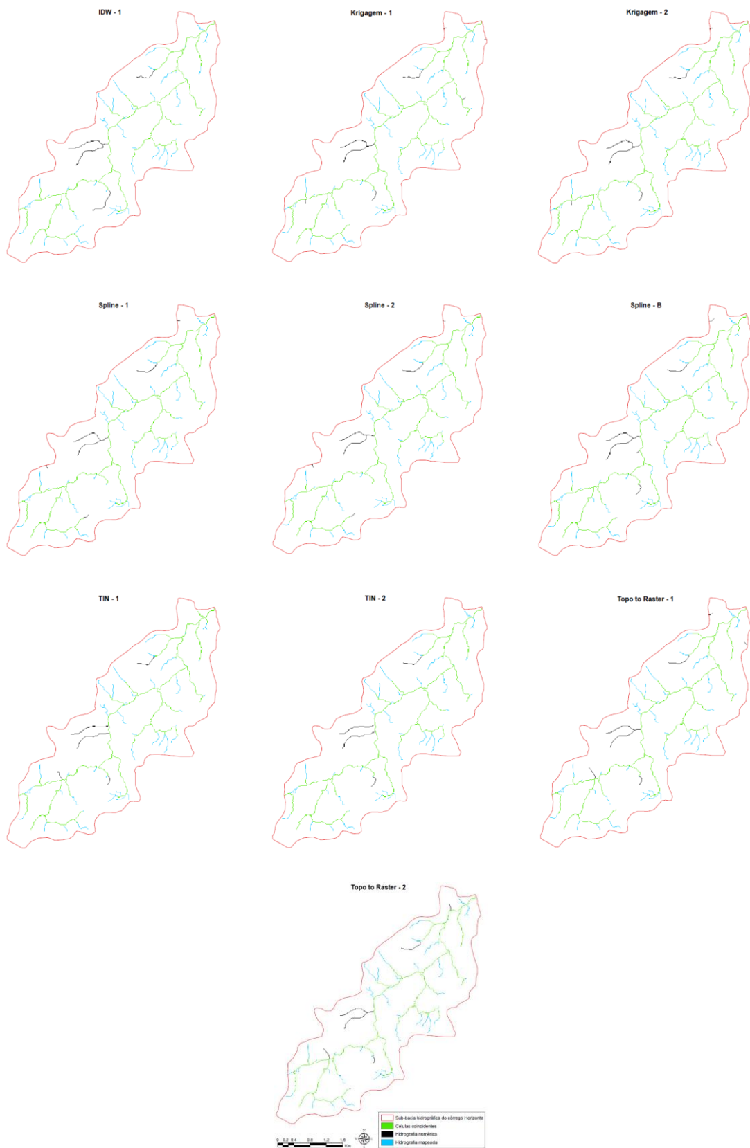
Figura 34 – Coincidência (verde) entre a hidrografia mapeada (azul) e a hidrografia numérica (preto) dos MDEHC gerados (IBGE) com a técnica de Stream Burning .
