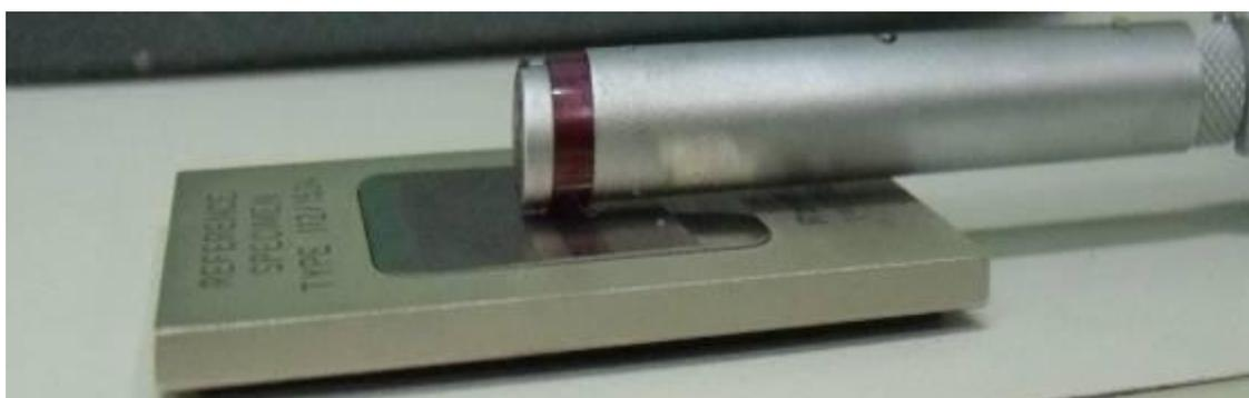
**Figura 5: Calibração do rugosímetro utilizado para determinar a rugosidade superficial dos corpos-de-prova**
