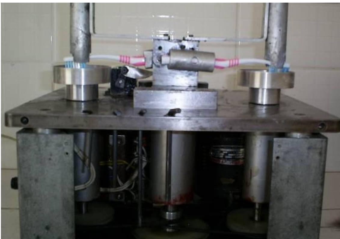
Figura 7A: Máquina de escovação simulada usada no teste de abrasão
