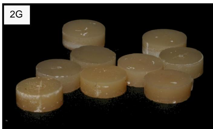
**Figura 2G:** Corpos-de-prova prontos, após remoção das saliências laterais.
