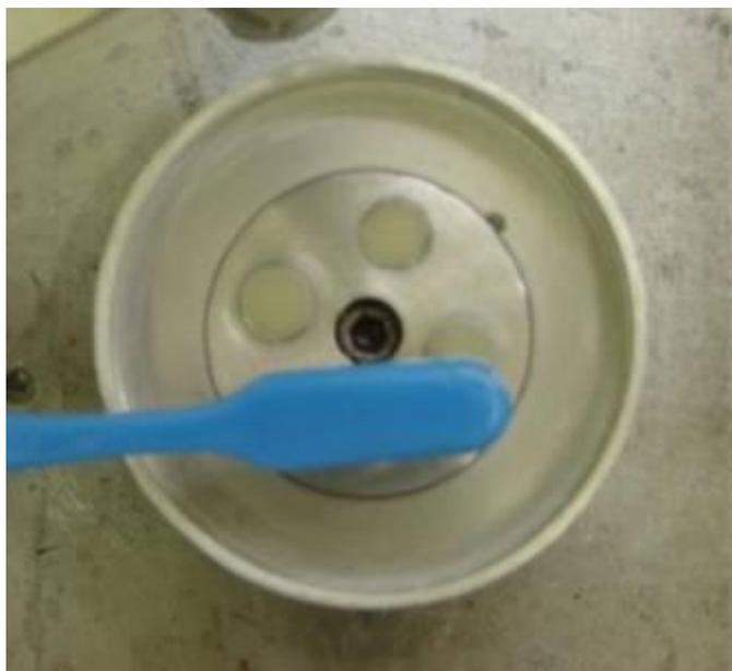
**Figura 7B: Vista aproximada da matriz onde são posicionados os corpos-de-prova**
