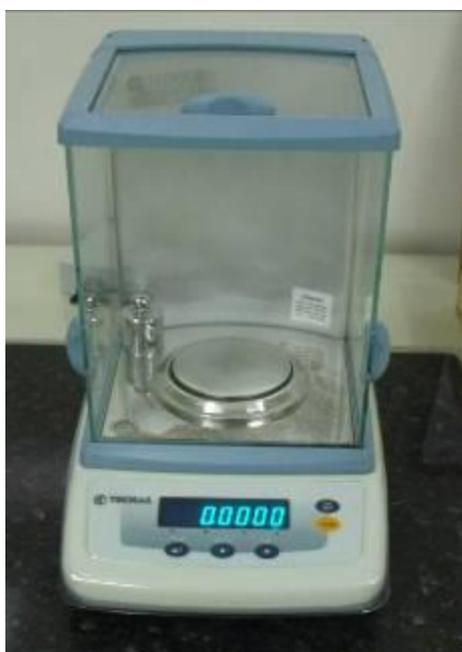
**Figura 3A: Balança eletrônica utilizada para determinação de massa dos corpos-de-prova**
