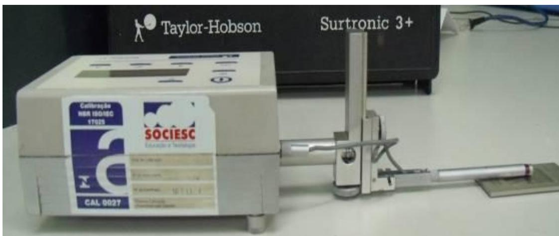
**Figura 4: Rugosímetro utilizado para determinação da rugosidade superficial dos corpos-de-prova**
