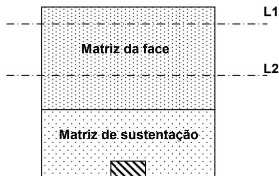
Figura 10: Esquema do posicionamento das medições de dureza (LOZZER, 2008)
