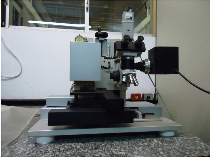
Figura 29: Microdurômetro Fischerscope H100V utilizado nos ensaios (LFS/USP)
