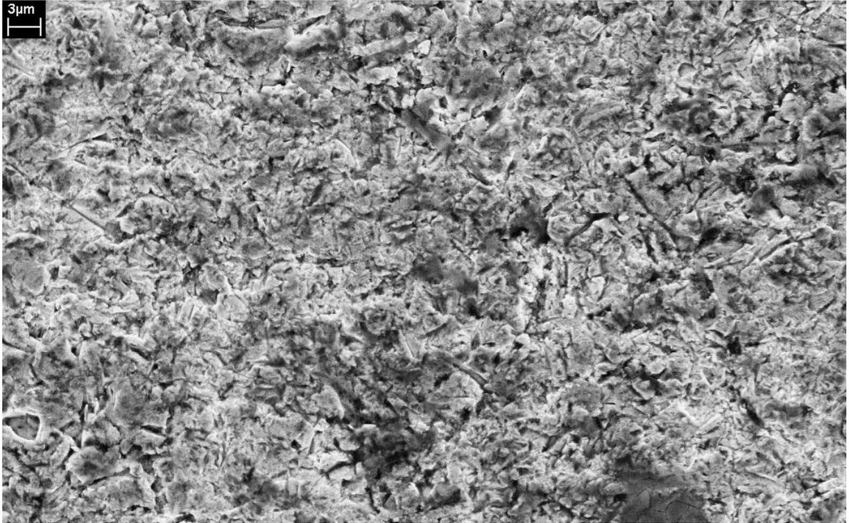
Figura 16: Micromecanismo de desgaste por indentações múltiplas gerados com lama abrasiva de SiC, MEV – elétrons secundários – amostra “4-SiC” (LOZZER, 2008)
