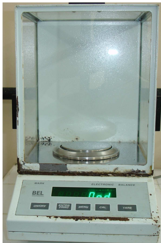
Figura 3.1: Balança Eletrônica, BEL - engineering, MARK. 0.0001, Faixa: 0-200g.
