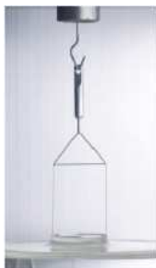
Figura 3.5: Anel utilizado pelo tensiômetro para medição da tensão superficial.
