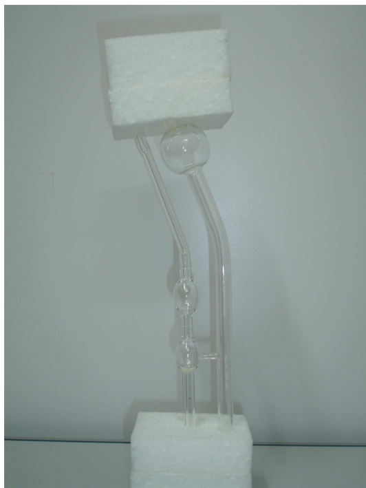
Figura 3.2: Viscosímetro utilizado na medição da viscosidade do fluido de teste.
