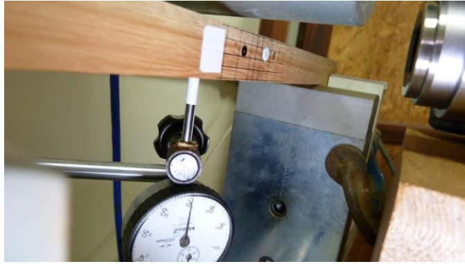
Figura 11. Detalhe do posicionamento dos equipamentos e do corpo-de-prova com os segmentos de reta e o círculo negro.
