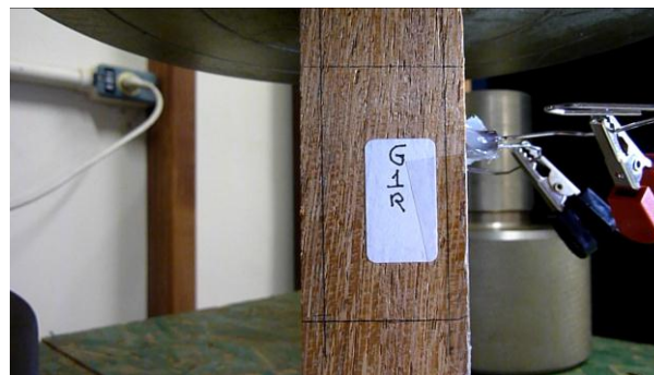
Figura 15. Esquema adotado para o ensaio de compressão paralela às fibras.
