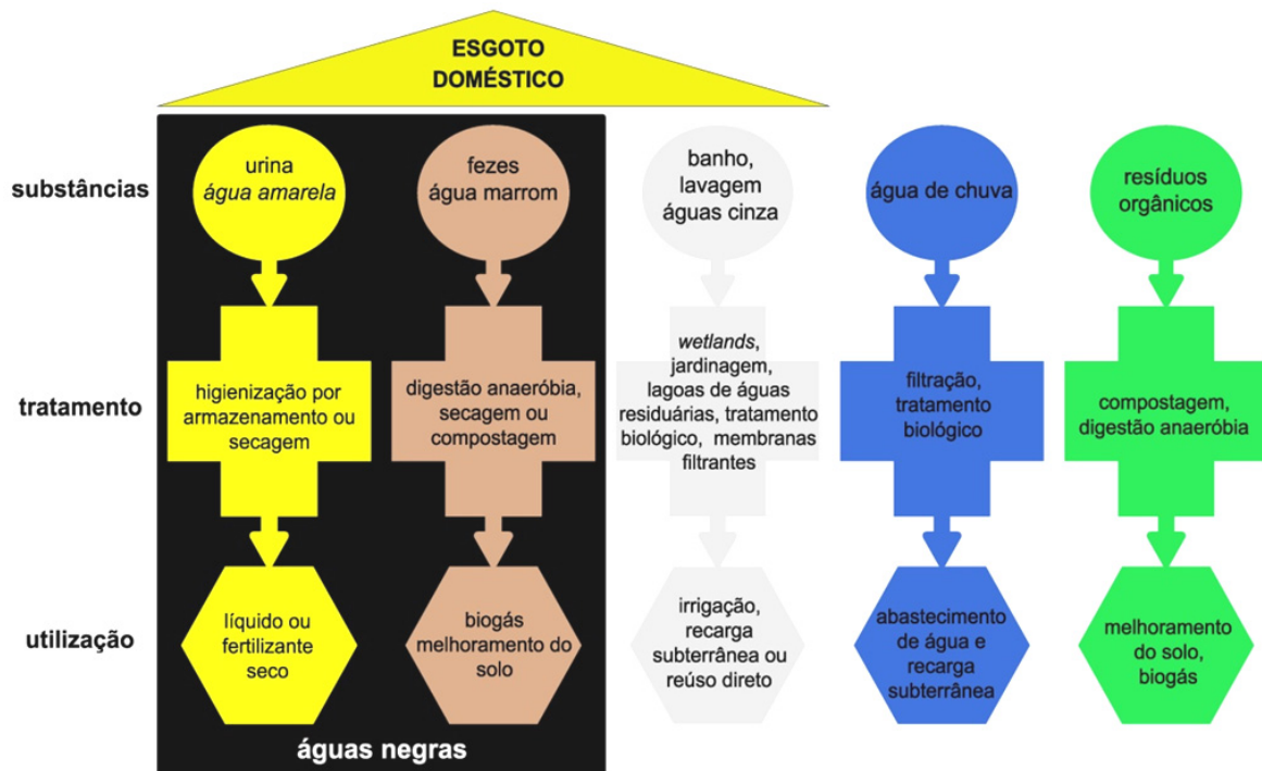
Figura 2: A separação dos elementos do saneamento ecológico e os exemplos de possíveis tratamentos e utilizações. Fonte: Adaptado de UNESCO/IHP & GTZ (2006, p. 15).
