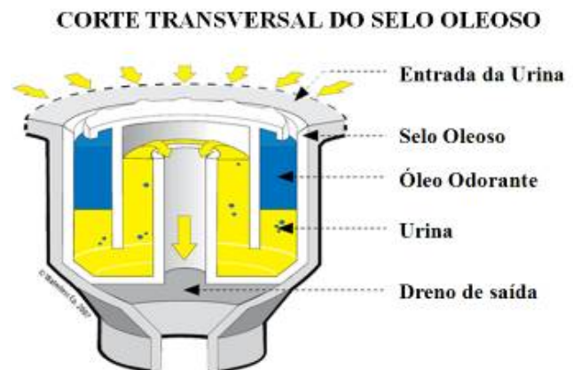
Figura 9: Dispositivo com selo oleoso. Fonte: WATERLESS (2003).
