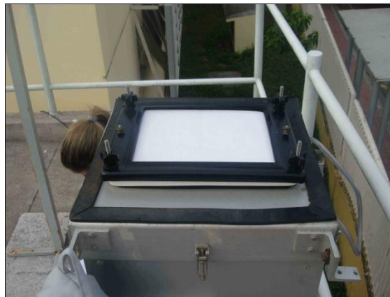
Figura 5-6: AGV sem a proteção, com o filtro e fibra de vidro exposto.
