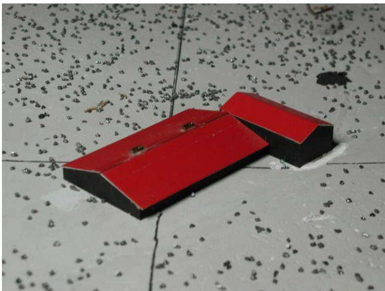
Figura 5-5: detalhe do modelo do prédio utilizado nos experimentos em túnel de vento (CEDVAL, 2006).
