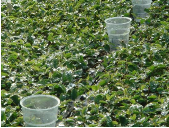
Figura 3A – Coletores com diâmetro de 8,5cm de abertura, para medição do volume de irrigação.
