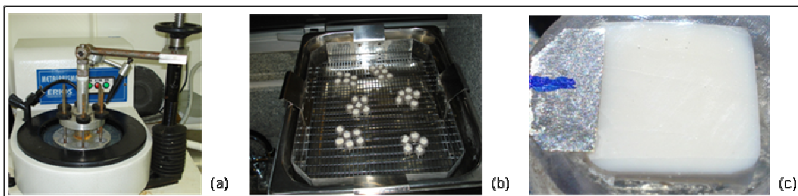
Figura 10: Preparo dos espécimes. (a) Polimento. (b) Lavagem em ultrassom. (c) Espécime com matriz de aço.
