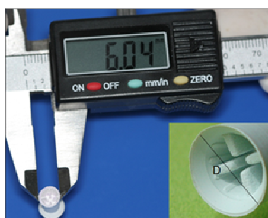
Dimensão aproximada das pontas medidas pelo paquímetro digital SCANGRIP®: (a) - Ponta aplicadora Cônica®; (b) - Ponta aplicadora Taça® (D= diâmetro); (c) - Ponta aplicadora Opal Cups®
