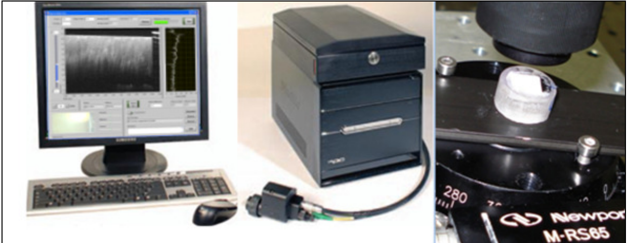
Figura 23: Sistema de OCT que foi utilizado no experimento OCP930SR (Thorlabs Inc.)
