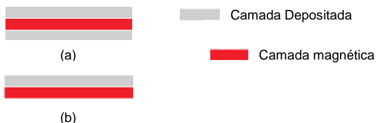
Figura 3.1: (a) Tricamada com camadas externas de Níquel e camada interna magnética FINEMET. (b) Bicamada com camada externa de Alumínio e camada interna METGLAS.
