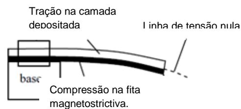
Figura 5.2: Figura esquemática de uma bicamada sujeita a uma curvatura dando origem a uma linha de tensão nula, ocorrendo tração na camada externa e compressão na fita magnetostrictiva [58].
