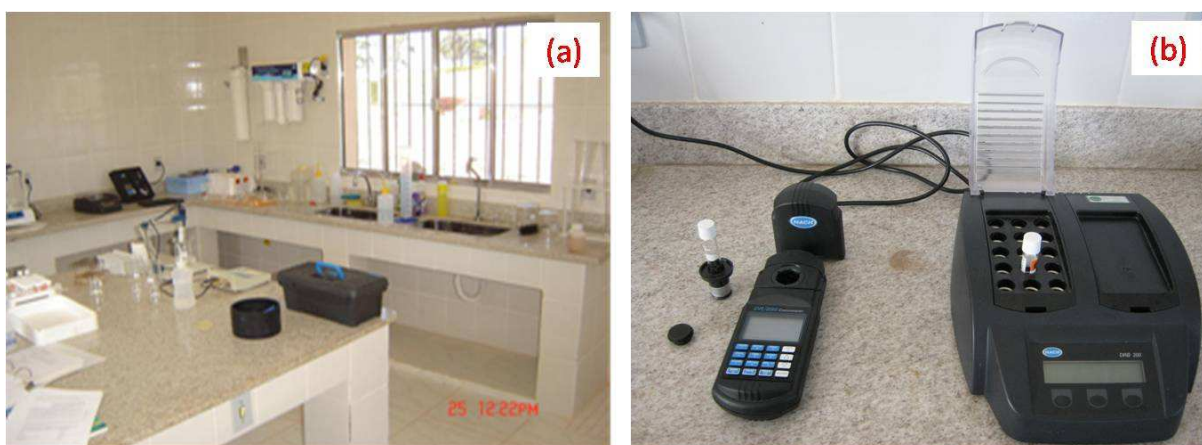
Figura 9. Instalações do Laboratório de análise de efluentes da CTRVV (a), bem como equipamentos da marca HACH utilizados nas análises (b).
