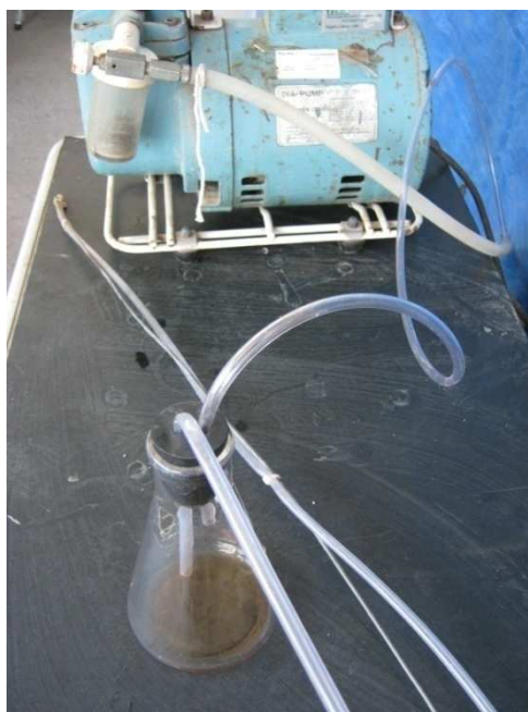
Figura 10. Sistema de recolhimento da espuma.
