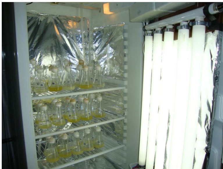
Figura 14 – Fotografia mostrando a Distribuição dos erlenmeyers na câmara incubadora com agitação periódica e mudança de posição na fila durante os ensaios ecotoxicológicos com S. costatum .
