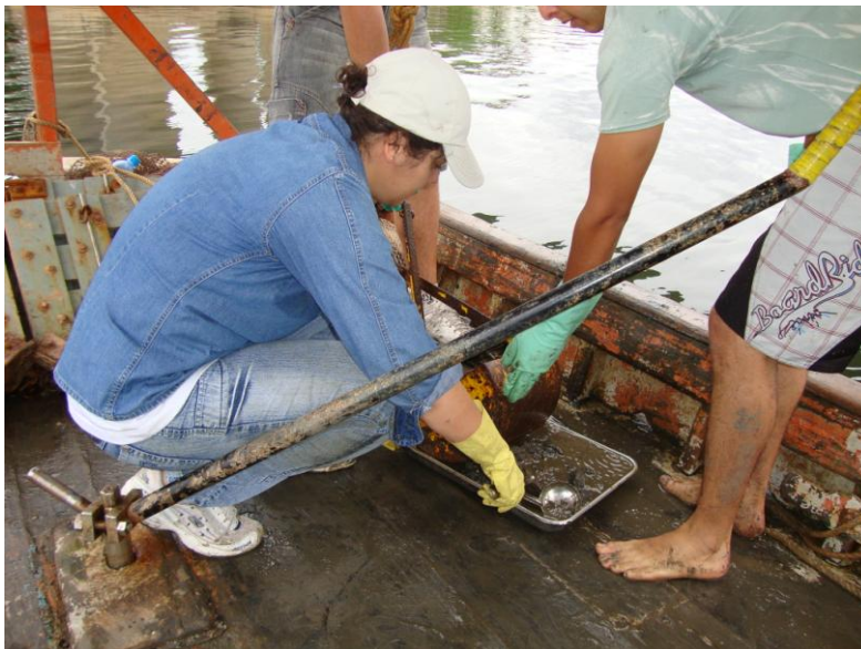
Figura 10 – Manuseio das amostras com bandeja e demais utensílios de alumínio durante a coleta na Baía de Vitória/ES.
