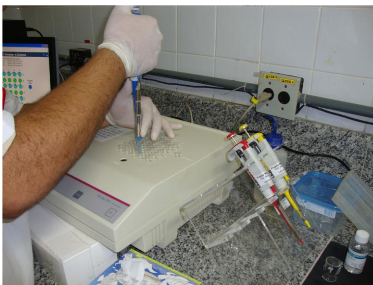
Figura 16 – Fotografia mostrando Preenchimento das cubetas de teste no termobloco do Microtox®.
