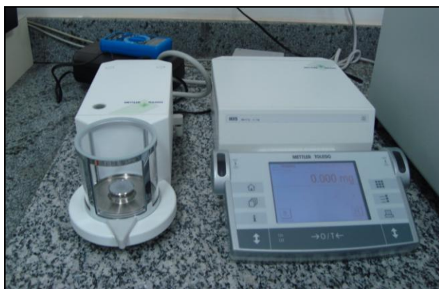
Figura 5-5: Balança analítica Mettler Toledo do LABPETRO-UFES utilizada para análise gravimétrica.
