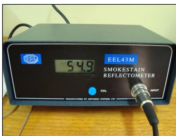
Figura 5-7: Refletômetro usado para a quantificação do BC.
