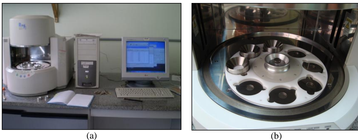
Figura 5-8: (a) EDX utilizado para quantificação elemental das amostras, (b) disco onde as amostras são colocadas para análise elemental.
