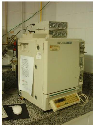
Figura 4.6 – Cromatógrafo gasoso Shimadzu GC-14B.
