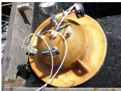
Figura 4.7 – Câmara de fluxo posicionada sobre a superfície do líquido no decantador do reator UASB.
