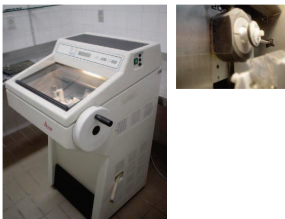
Figura 10 - Criostato Jung CM 1800 – Leica, pertencente ao Departamento de Patologia do Centro Biomédico da Universidade Federal do Espírito Santo. Em detalhe, o bloco de gelatina posicionado pronto para a obtenção de cortes transversos da aorta.
