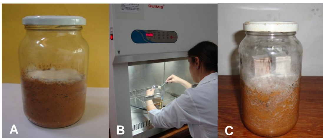
Figura 1. Introdução dos corpos de prova nos frascos. A - Frasco com fungo inoculado sobre as placas alimentadoras; B - Introdução dos corpos de prova nos frascos assepticamente; C - Frasco com corpos de prova já inoculados.
