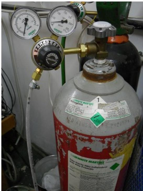
Foto 3.7 – Cilindro de gás utilizado: *Nitrogênio White Martins 4.6*. O controlador utilizado é de um cilindro de gás Argônio por ser compatível ao controlador de gás Nitrogênio.
