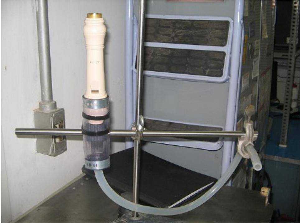
Foto 3.6 – Montagem do soprador artificial acoplado ao bocal da flauta doce.
