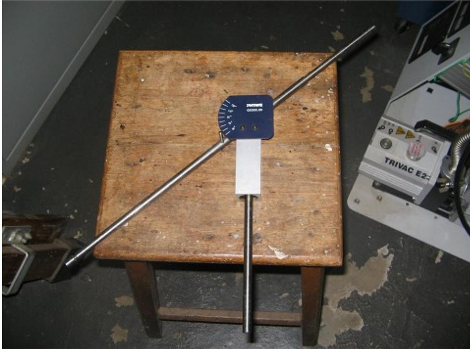
Foto 3.14 – Equipamento utilizado para a medição do ângulo entre o microfone e o bocal em uso em relação ao chão.
