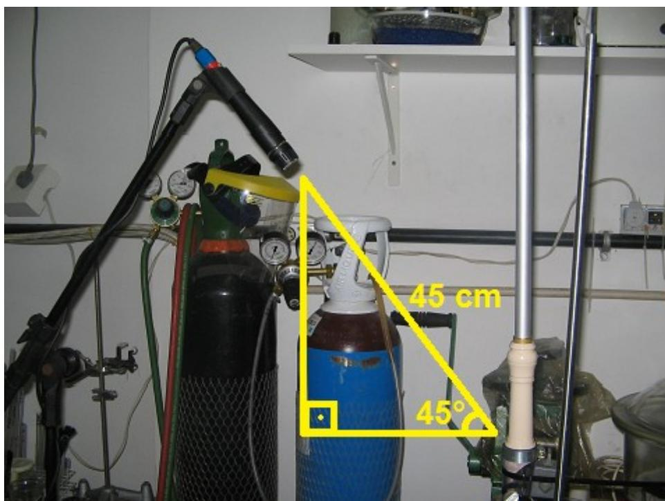
Foto 3.13 – Posicionamento do bocal acoplado ao soprador artificial em relação ao microfone. O ângulo de 45° e a distância de 45 cm entre o bocal e o microfone são valores aproximados.
