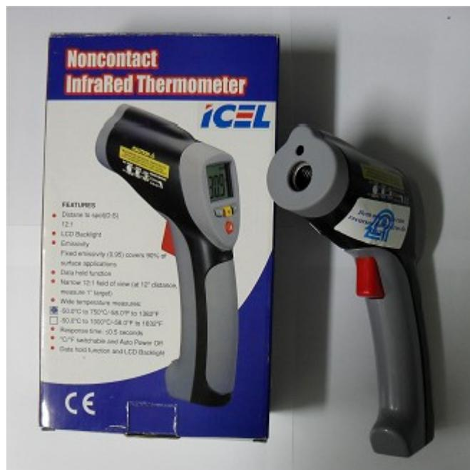
Foto 3.9 – Termômetro digital infravermelho utilizado para a captura dos sinais nas experiências.
