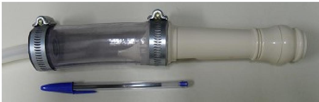
Foto 3.4 – Bocal da flauta doce contralto (sem o adaptador) acoplado à entrada do soprador artificial.
