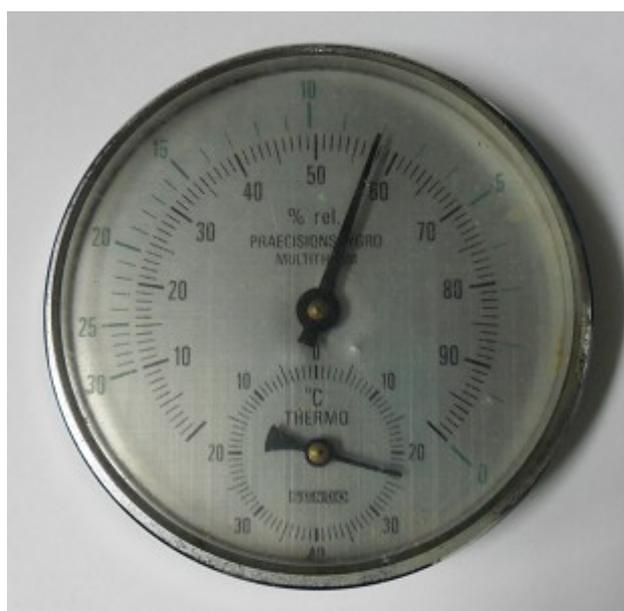
Foto 3.11 – Medidor de umidade e temperatura utilizado.
