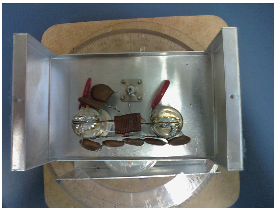
Figura B.3: Fotografia da sonda construída especificamente para realização de experimentos de RQN de ^{23}\text{Cl} em um monocristal de \text{KClO}_3 .
