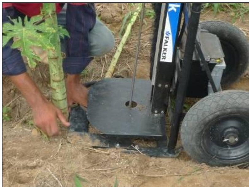
Figura 5. Posicionamento do penetrógrafo no sentido longitudinal
