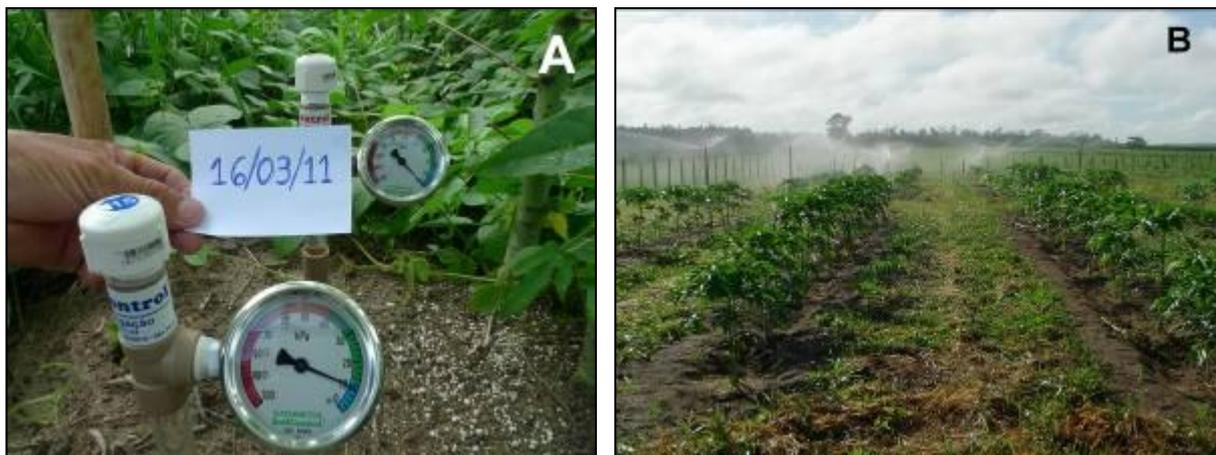
Figura 4. Leitura do tensiômetro (A); funcionamento da irrigação (B)
