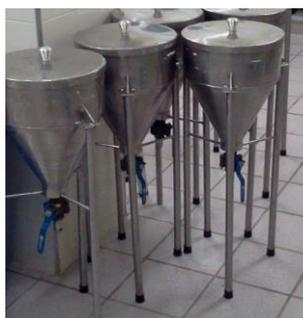
**Figura 4:** Percoladores utilizados na fabricação dos extratos fitoterápicos na PSVNI
