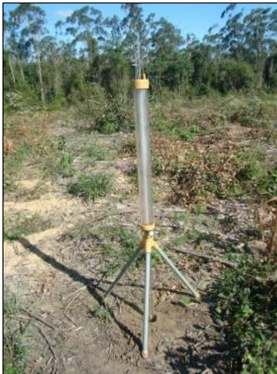
Figura 2. Permeâmetro de Guelph em ensaio de condutividade hidráulica dos solos das microbacias.
