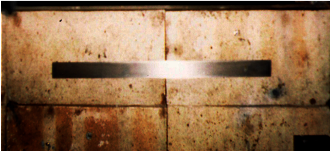
Figura 2.7: Segunda tentativa de produção de corpo de prova. Lâmina de aço carbono AISI 1020, sobre a qual se verteria chumbo fundido.
