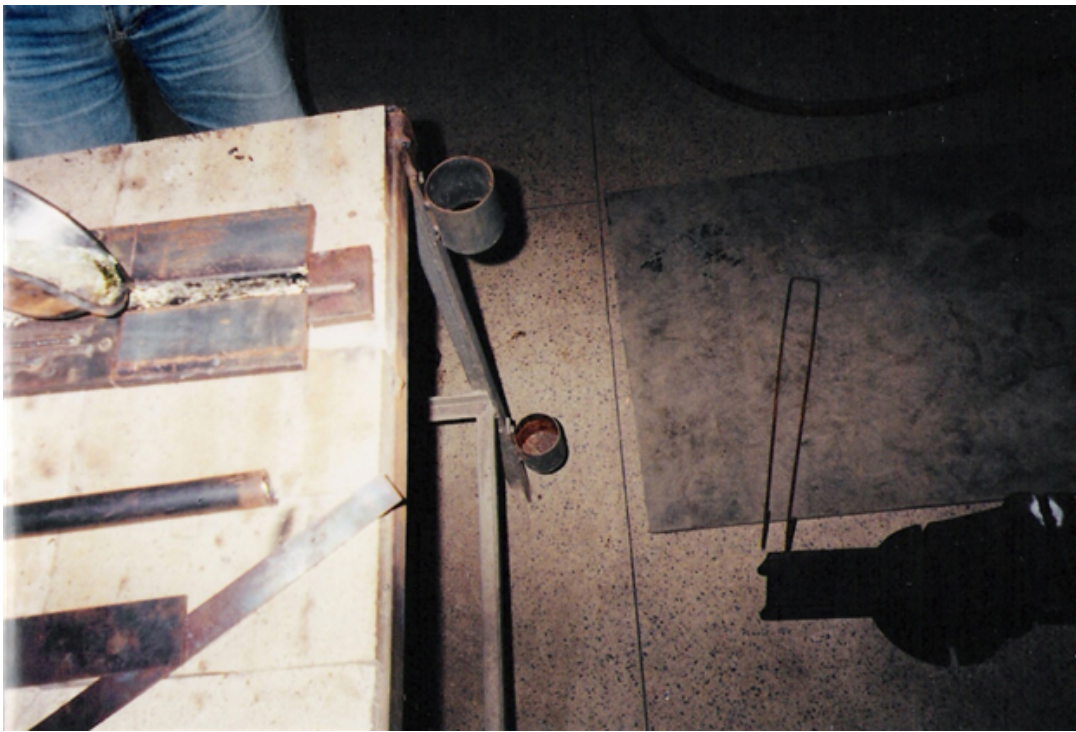
Figura 2.9: Chumbo líquido sendo vertido sobre a lâmina de aço carbono AISI 1020.
