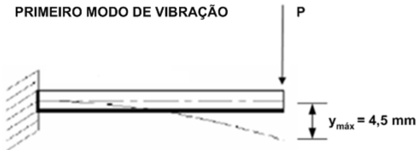
Figura 2.26: Primeiro modo de vibração de uma viga engastada em uma de suas extremidades e com carga aplicada na extremidade livre. Mostrada a linha neutra quando se atinge a deflexão máxima.
