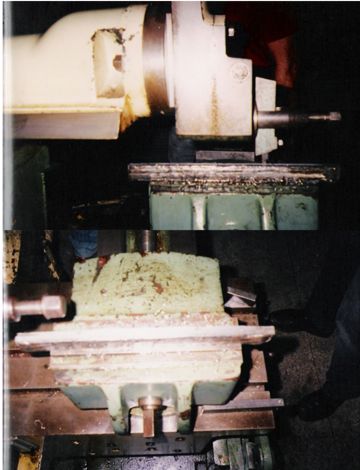
Figura 2.5: Aplainamento do corpo de prova produzido por soldagem MIG/MAG.
