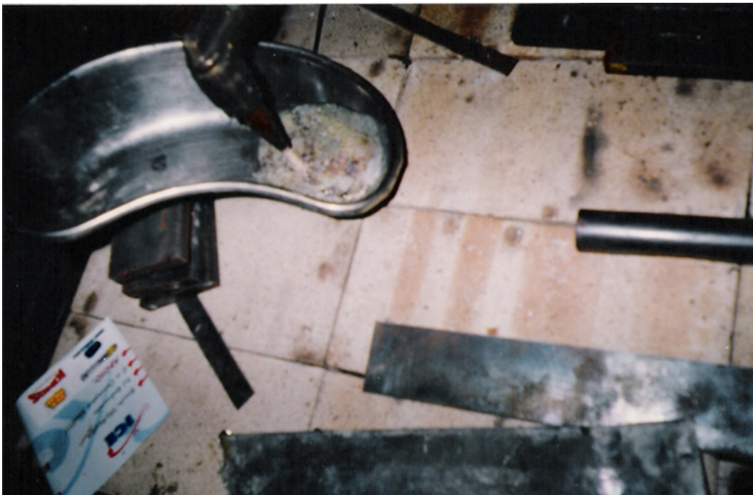
Figura 2.8: Recipiente contendo chumbo no estado líquido.
