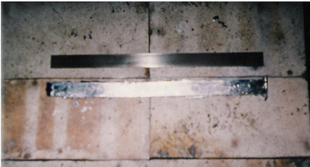
Figura 2.10: Imagem mostrando a separação entre a lâmina de aço carbono AISI 1020 e o chumbo solidificado, causada pela baixa molhabilidade.
