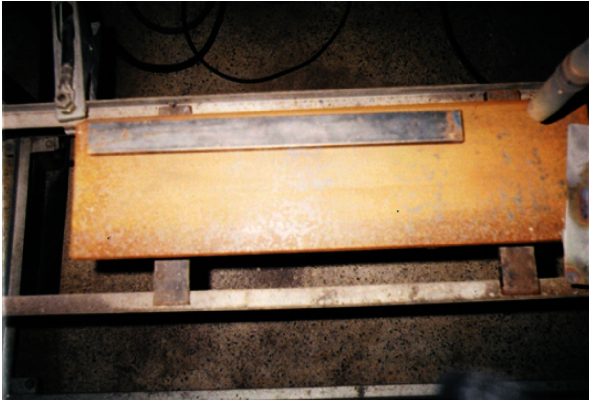
Figura 2.2: Chapa de aço carbono AISI 1020 ponteadada - 05 pontos em cada lado - para receber passes de soldagem.
