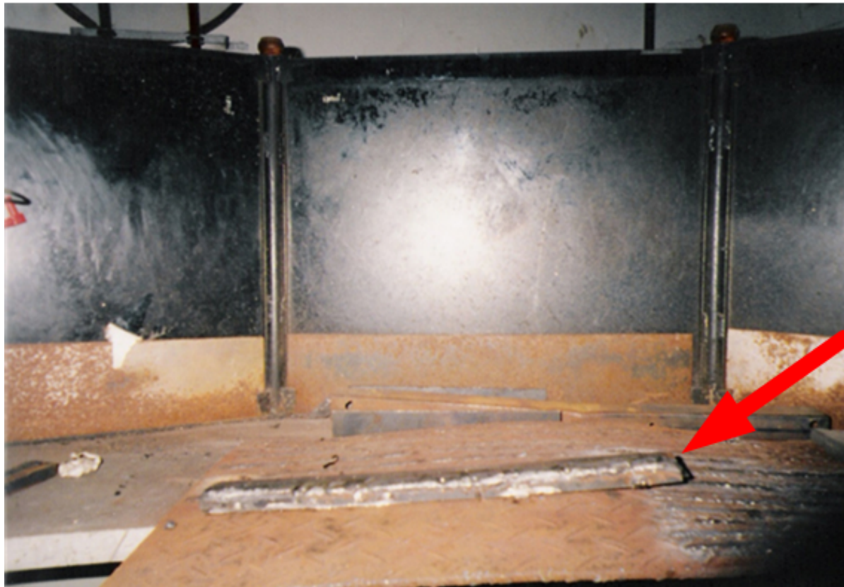
Figura 2.4: Lâmina de aço carbono 1020, com deposição de quatro passes de aço inoxidável AISI 308. Corpo de prova imediatamente após ter sido efetuado o desponteamento.
