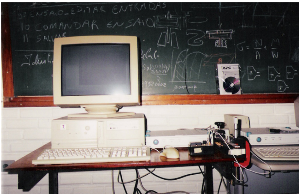
Figura 2.23: Sistema de aquisição de sinais, tratamento e análise de dados. Sala do Laboratório de Ensaio de Materiais de Construção da Universidade Federal do Espírito Santo.
