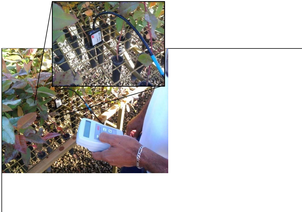
Figura 4. Medição direta no substrato com o sensor de temperatura e umidade e aferição do potencial hídrico foliar com a câmara de pressão
