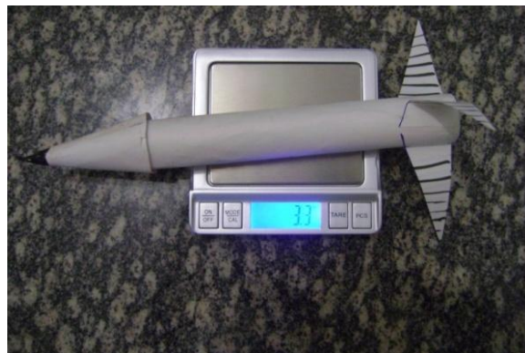
Figura 66 - O diâmetro de um cilindro medido pelo paquímetro (a) e a massa do foguete sendo determinada com uma balança eletrônica de precisão (b)
