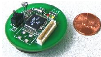
Figura 2.3: Exemplo de um nó sensor de uma RSSF
