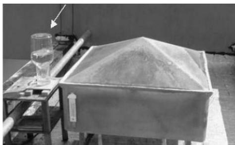
Figura 11: Destilador utilizado para produção de água doce a partir de água salgada ou salobra. Fonte: Soares, 2004.
