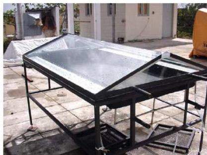
Figura 10: Destilador utilizado para evaporar água presente no efluente de produção de petróleo para reúso na agricultura e geração de vapor. Fonte: Bezerra, 2004.
